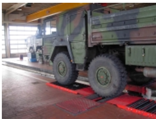
Serie de rodillos para la comprobación de camiones con ejes de tracción de unión rígida
