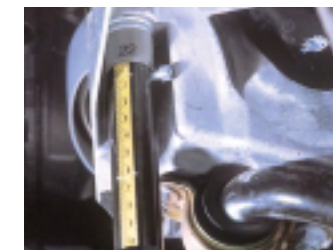
El tubo de medición y el adaptador encaja sobre la cabeza del tornillo en lugares estrechos.
