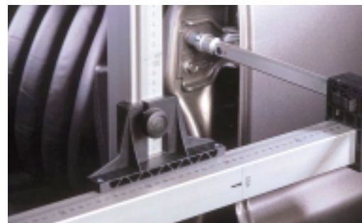
Los puntos de medición en la parte superior de la carrocería quedan fácilmente accesibles con el sistema opcional M900.
