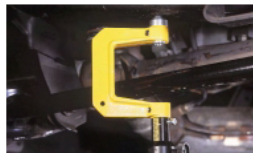
El adaptador opcional de medición M217 es útil para los puntos de medición en lugares de difícil acceso.
