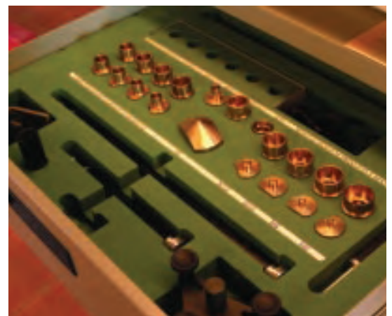
PROLONGADORES Y ADAPTADORES DEL EQUIPO PARA EL CORRECTO AJUSTE DE LOS PUNTOS DE CONTROL.
