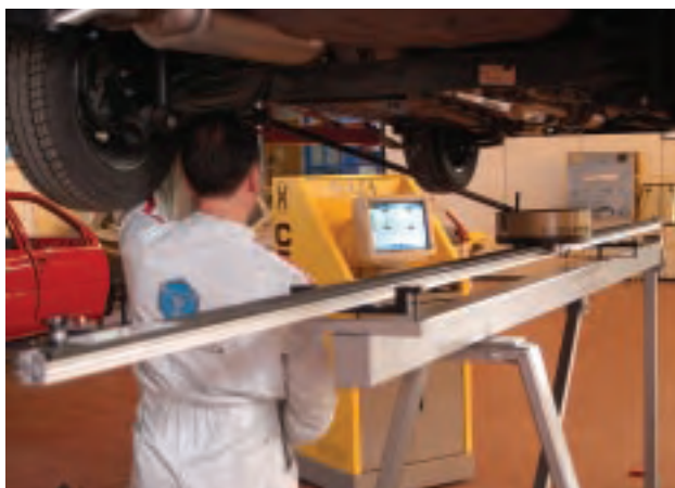
MEDIDOR NAJA COLOCADO SOBRE LA GAZELLA PARA LA COMPROBACIÓN DE LAS COTAS DE UN VEHÍCULO MONTADO SOBRE UN ELEVADOR DE 2 COLUMNAS.
