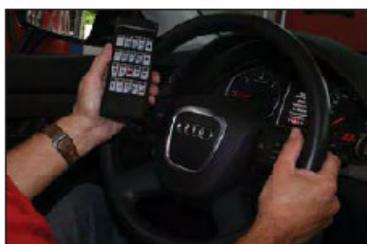
Con el control remoto opcional puedes controlar el equipo desde el asiento del conductor, por el conductor, pudiendo manipular las funciones, ej.: Solo iniciar prueba, o realizar la prueba con una secuencia determinada, ...
