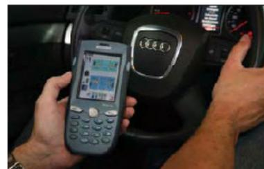
La opción PWA (pocket workshop assistant) es un pocket PC con el software de la línea y con el control remoto integrado, pudiendo reemplazar cualquier otro tipo de display, como el display cabinet o monitor. Todo el proceso está controlado desde el asiento del conductor. Solo las funciones claves están reflejadas en la pantalla.
