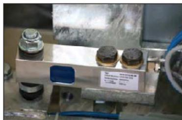
El registro de los valores a medir tiene lugar a través del acreditado principio de medición DMS. Estos sensores de medición, antidesgaste, determinan con gran fiabilidad y sin errores las fuerzas resultantes
