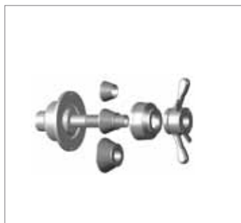
Dispositivo de centrado estándar tuerca de velocidad, con kit de 3 conos, rango de centrado de 42 a 111,5 mm, aro de centrado y cazoleta cónica de presión
