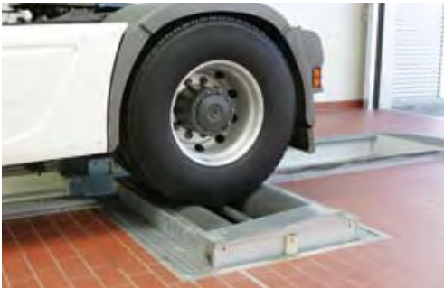
Juego de rodillos con sistema elevador
